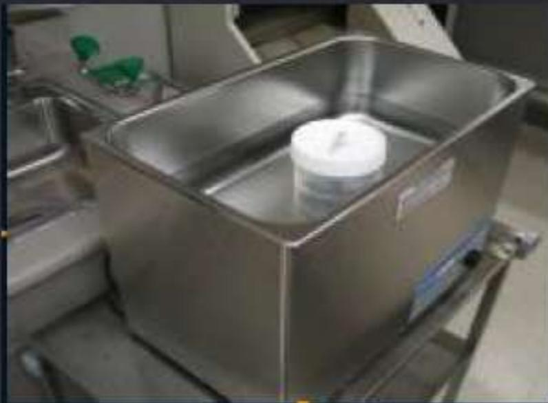
ультразвуковая обработка в течение 5 минут при частоте  $40 \pm 2$  кГц и плотности  $0.22 \pm 0.04$  Ватт/см<sup>2</sup>
